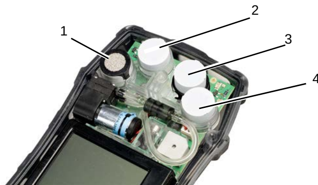
Bild 14 Mögliche Positionen für den Austausch von Sensoren
