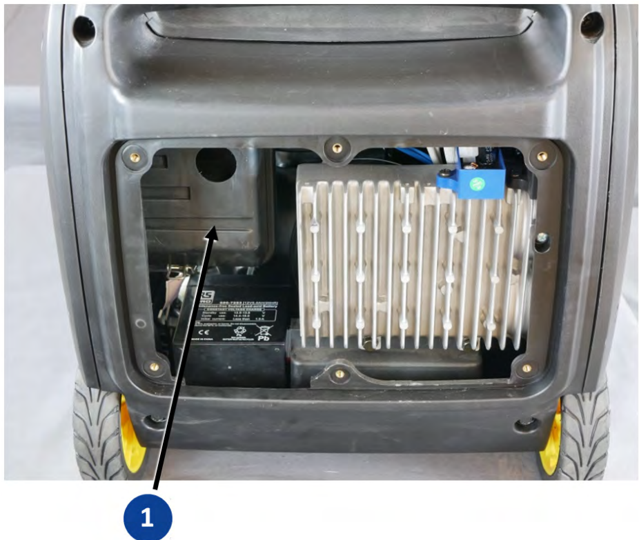
Abb. 9-5 Luftfilter hinter Lüftungsgitter (entfernt)
