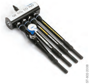
Impactor mit Adapter im Aerotest Simultan
