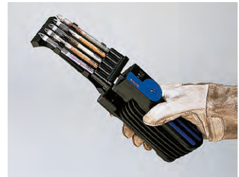
Messung mit dem Simultantest-Set
