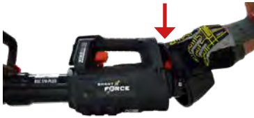
Abb. 3: Kontrolle der Dichtung sowie des Gehäuses
