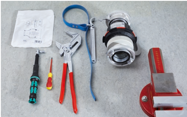
Standardwerkzeug bereithalten und Gerät in Schraubstock einspannen.
