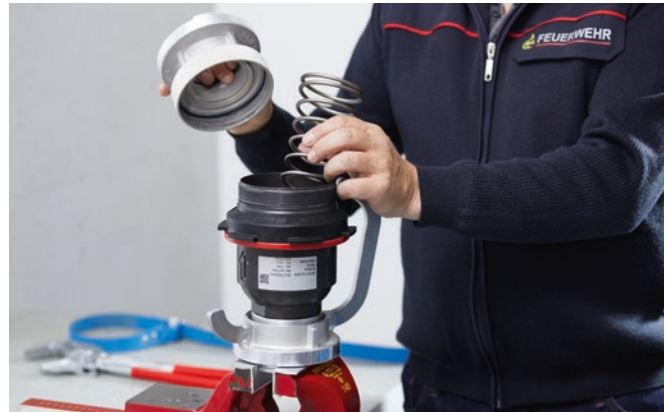
Deckel öffnen und die spannungsfreie Feder entfernen.
