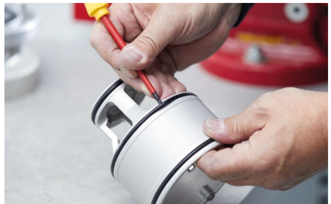
Dichtringe bei Bedarf tauschen. Danach Zusammenbau in umgekehrter Reihenfolge und Systemtrenner prüfen.
