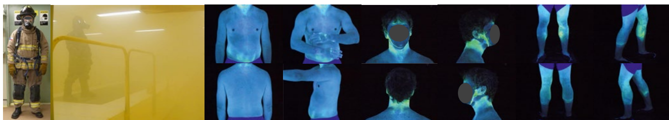
Abbildung 1: Ergebnisse der FAST Studie. In der Studie wurde Modellrauch mit fluoreszierenden 2,5 µm großen Silikatpartikeln (SiO 2 ) erzeugt und die Einsatzkräfte diesen exponiert. Anschließend wurde die Fluoreszenz mittels UV-Licht sichtbar gemacht. Es zeigt sich, dass die Einsatzkleidung vor allem an den Übergangsstellen durchlässig ist. Dies ist im Bereich der Maske der Fall, am Übergang von Jacke und Handschuhe (Arm), von Jacke zu Hose (Bauch) und am Übergang von der Hose zu den Schuhen (Bein). 4
