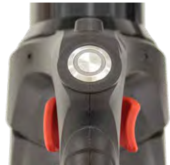
Beispiel Schneidgerät: links schließen, rechts öffnen
