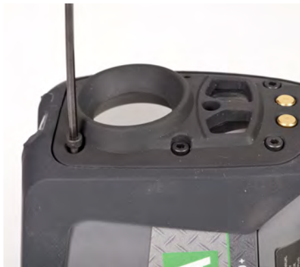
Bild 17 Germaniumlinsenaufnahme, zu entfernende Schrauben
