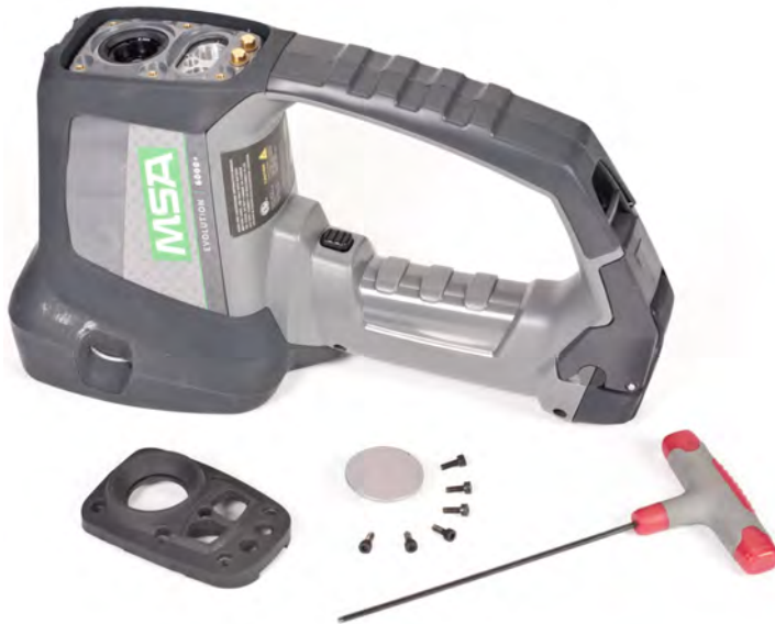
Bild 16 Germaniumlinsenaufnahme, Teile und Werkzeug
