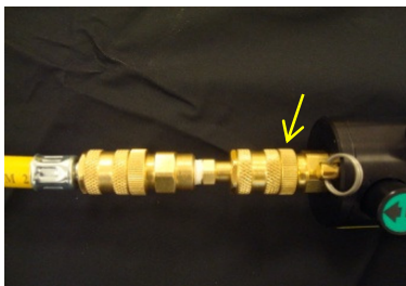
Step 4: Secure the lock (controller input)
