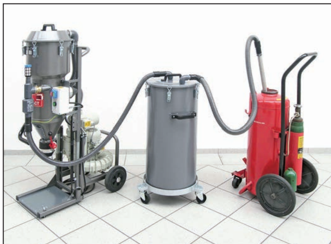
Bild 3: Mit einem 50- oder 250-kg-Zusatzbehälter können mit der PSM COMPACT auch fahrbare Feuerlöscher gewartet werden. Bei Servicearbeiten beispielsweise an 50-kg-Feuerlöschern wird das Löschpulver aus dem fahrbaren Feuerlöscher zunächst in den separaten Zusatzbehälter gesaugt.
