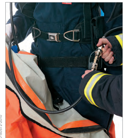
Verbindung der Druckluftschlauchleitung mit dem Pressluftatmer im Anzuginneren
