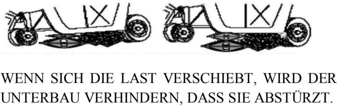
Abbildung 2-3. Korrekte Vorgehensweise für das Unterbauen von Lasten.
