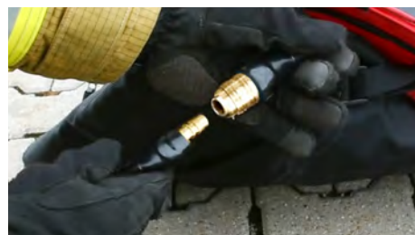
Druckluft-Kupplung: weiblich für Schlauchdurchmesser 9mm; Nennweite 7,2mm
