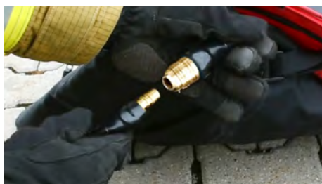
Druckluft-Kupplung: weiblich für Schlauchdurchmesser 9mm; Nennweite 7,2mm
