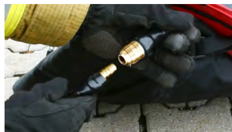
Druckluft-Kupplung: weiblich für Schlauchdurchmesser 9mm; Nennweite 7,2mm
