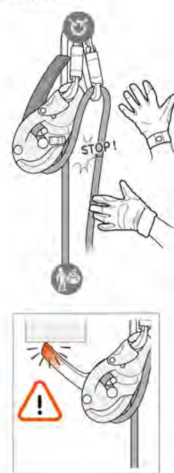
9c. Stop position Position d'arrêt
