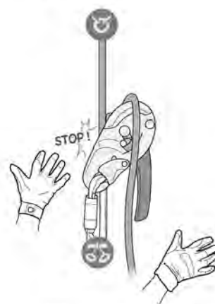
10c. Stop position Position d'arrêt
