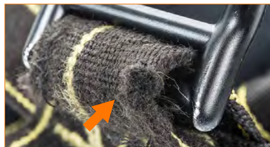
Hihna on erittäin kulunut rintakiinnityspisteen läheltä.
