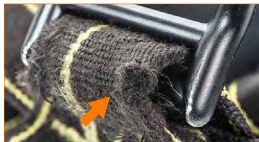
Fettuccia estremamente usurata in prossimità dell'anello ventrale.
