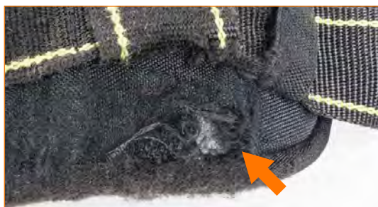
Imbottitura molto usurata. L'usura di parti non strutturali non è da sottovalutare perché può essere un indicatore generale dello stato di usura del dispositivo.
