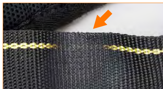
Hihnaan on tullut palojälkiä, sillä se on ollut lämmönlähteen lähellä.
