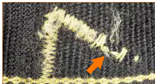
Costuras de seguridad con hilos cortados.
