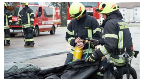
Aufbau in 90 Sekunden (bei 10 Bar Druck)
