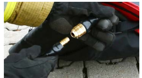
Druckluft-Kupplung: weiblich für Schlauchdurchmesser 9mm; Nennweite 7,2mm
