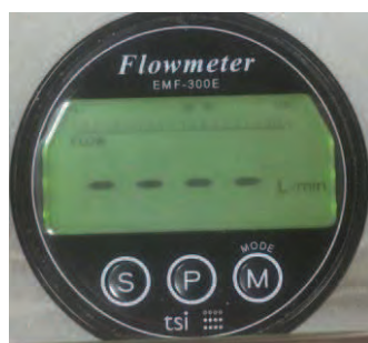
Abb. 6.2: Displayanzeige bei Selbsttest und danach im Betriebszustand
