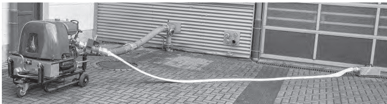
Abb. 4.3: Prüfung von Feuerwehrequipment mit Ein- und Auslaufstrecke
