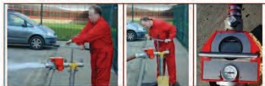
Abb. 3.1: Überprüfung eines Unterflurhydranten mit einem Standrohr. Beispiel für Durchflussmessung und Ablesen des Restdrucks. Fotos mit freundlicher Genehmigung von Essex County Fire and Rescue Service und Laois Fire Service.
