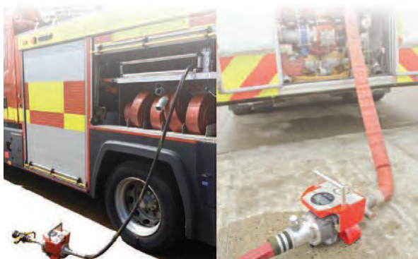
Abb. 4.3: Prüfung von Feuerwehrequipment mit Ein- und Auslaufstrecke
