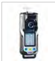
Dräger X-am 8000 mit Pumpenadapter
