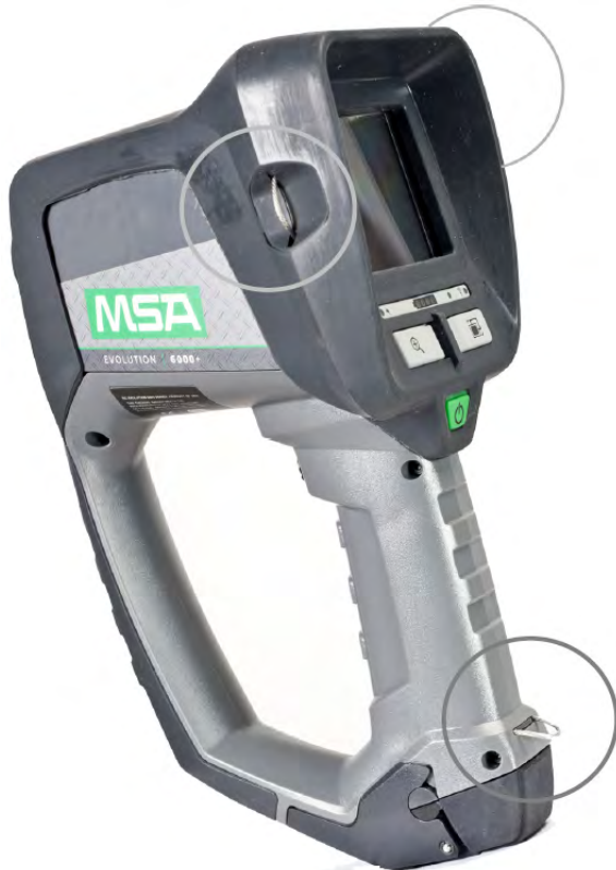
Bild 3 Lage der Befestigungsseile
