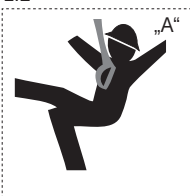
Sternal Fall arrest/ Absturzsicherung sternal
