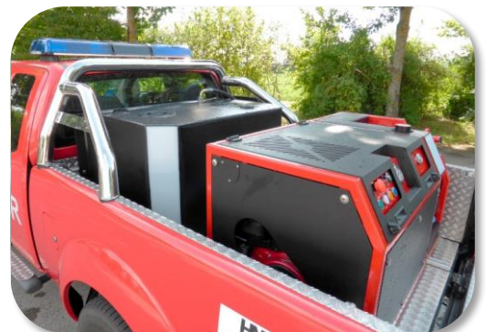
Beispiel: Leichter LKW mit MFU und Wassertank (500 Liter)
