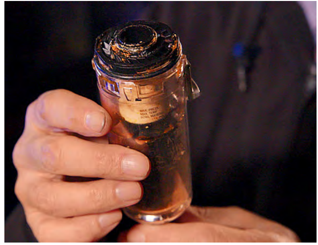
Beispiel eines verschmutzten Luftfiltergehäuses
