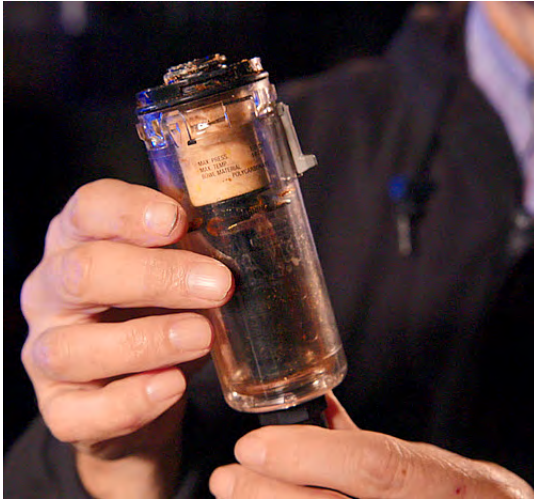
Beispiel eines verschmutzten Luftfiltergehäuses
