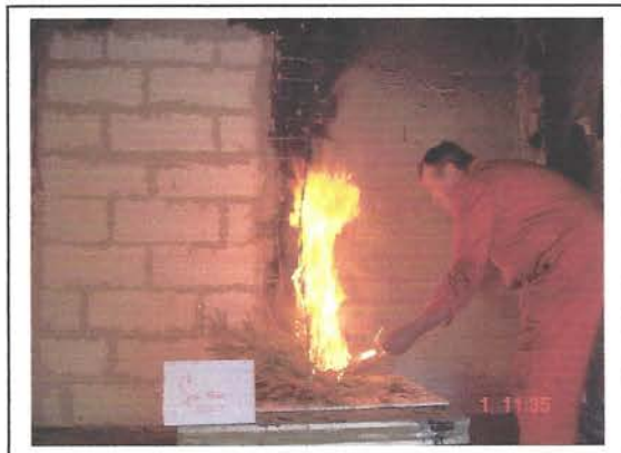
Abbildung 27: unbehandelte Fichte (10 s)
