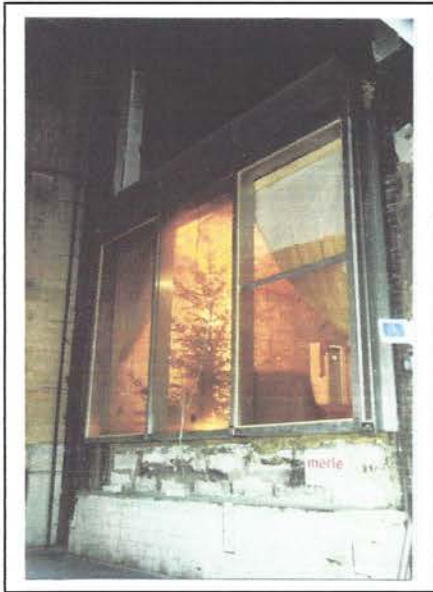
Abbildung 16: 15. sec Durchzündung des Baums
