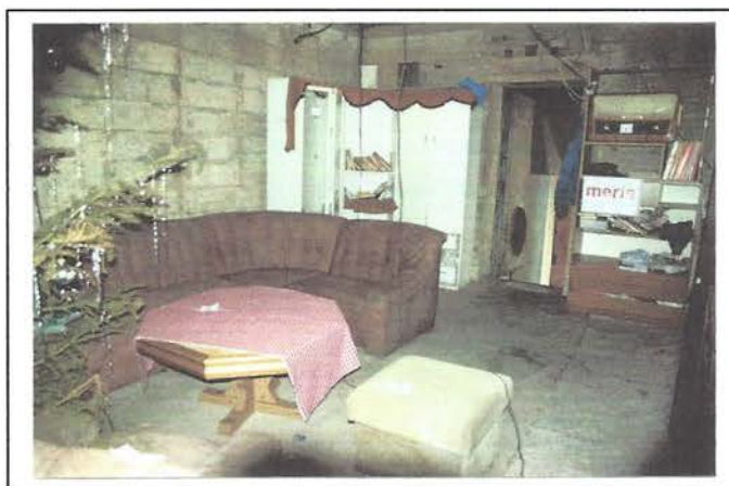
Abbildungen 12 und 13: Brandlastverteilung im Versuchsraum
