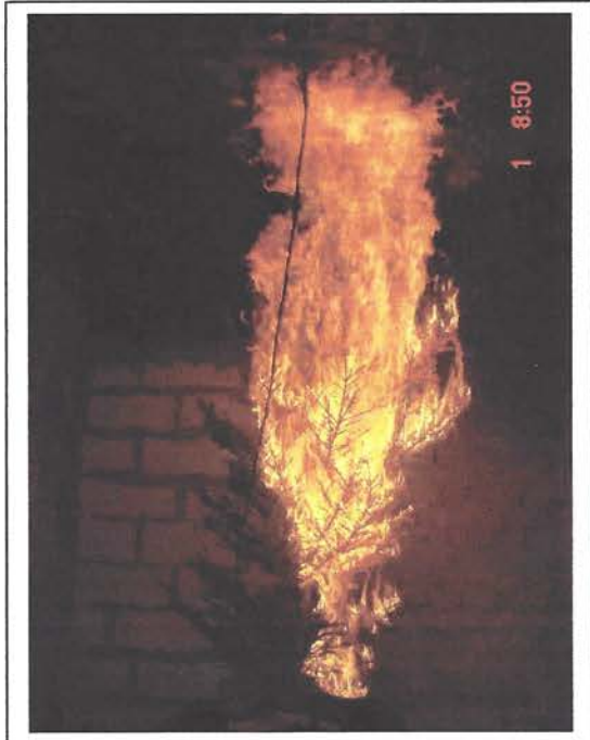
Abbildung 25: unbehandelte Fichte (30 s)
