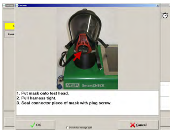
Bild 24 Anschließen einer Maske
