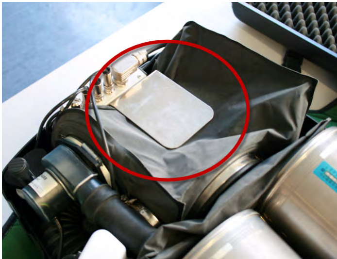
Bild 48 Sperren des Überschussventils am Ausatembeutel
