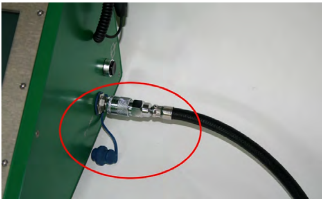
Bild 31 Anschließen der Mitteldruckleitung
