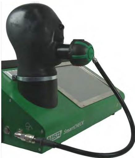
Bild 33 Schließen Sie den Lungenautomat an.
