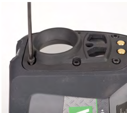
Bild 17 Germaniumlinsenaufnahme, zu entfernende Schrauben
