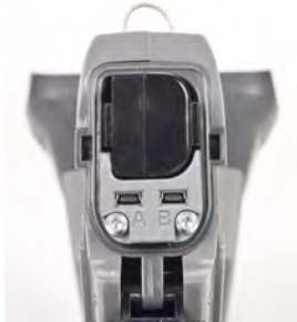
Bild 11 Lage der USB-Schnittstelle A
