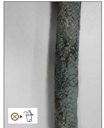
• Spuren von chemischen Produkten
