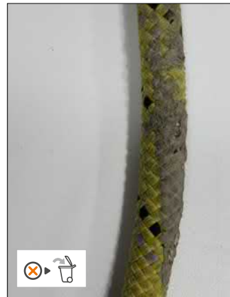
• Spuren von chemischen Produkten
