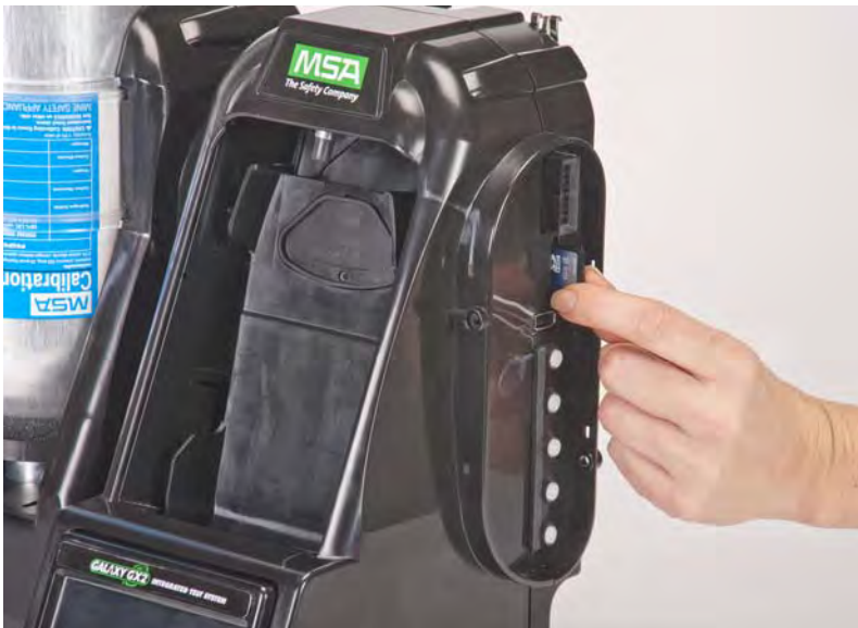
Bild 13 Installation der SD- oder SDHC-Speicherkarte
