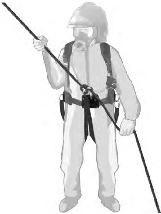
Bild 13 Verwendung von Rettungssitz/Rettungsschlaufe Typ B
