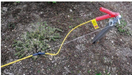
Erdung mit einem Erdungsspieß
