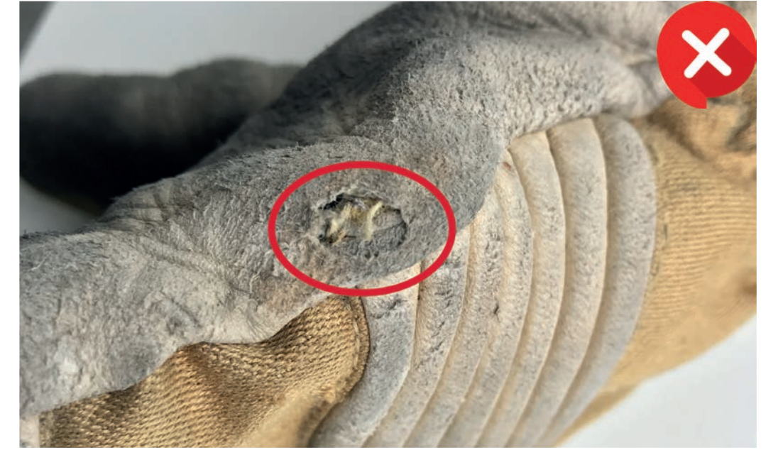
Loch durch Abrieb
