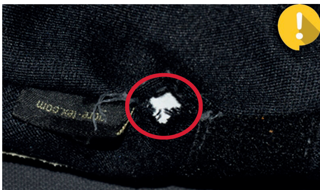
Öse ausgerissen / Offene Naht
