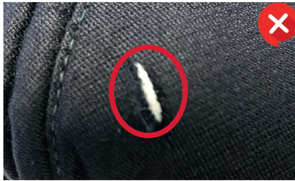
Loch durch Schnitt
