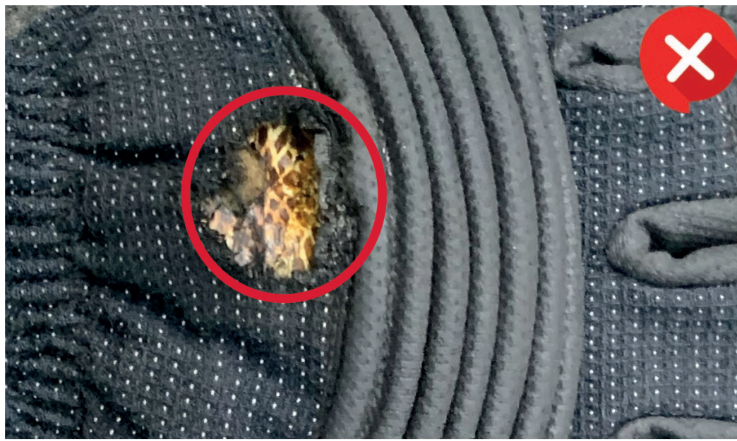
Loch durch flüssiges Metall
