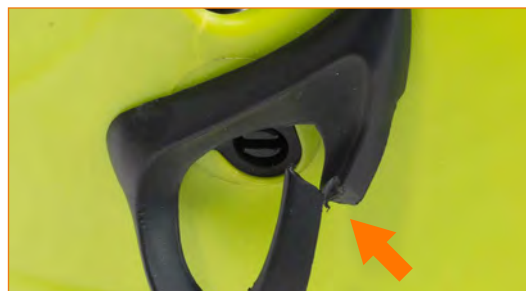
Rikkoutunut otsavalaisimen kiinnike.
