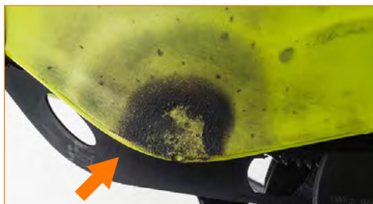
Kuori, jossa on palojälkiä.
