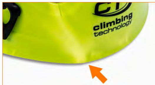
Yleinen kuoren muodonmuutos; materiaalissa näkyy merkkejä heikentymisestä.
