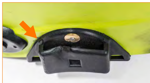
Kuulonsuojainten kiinnityspiste on käyttökelvoton. Vaiha sopivaan varaosaan.
