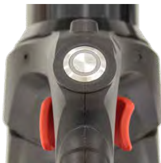
Beispiel Schneidgerät: links schließen, rechts öffnen
